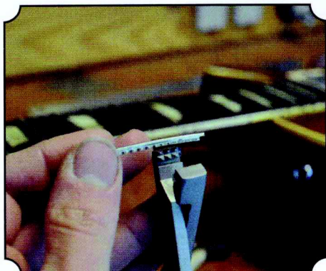
La pince à gauffer élargit le pied de frette pour mieux l'adapter à la rainure.
