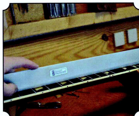
Le bon alignement des frettes est contrôlé en cours de travail. Les 3 premières et dernières frettes sont d'abord mises en place puis les 9, 10 et 11. Cela permet de vérifier la droiture du manche en cours de travail. Le pied de frette est travaillé afin de corriger le creux du manche.
