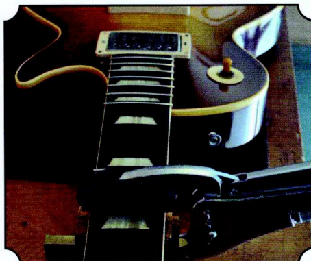
Les frettes sont de préférence pressées en place sur une guitare vintage. Le martelage est aussi possible mais les vibrations peuvent abimer les vernis fragiles.
