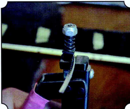
Le pied de frette est découpé avec une pince spécifique pour permettre le recouvrement de la frette sur le filet de touche.
