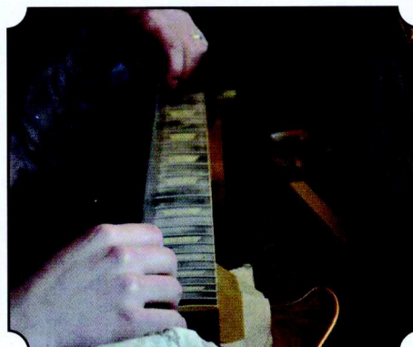
Une fois toutes les frettes en place, elles sont ajustées latéralement puis surfacées pour obtenir un plan de frettes parfaitement rectiligne.
